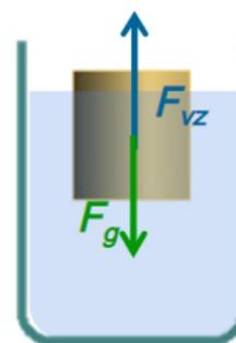
Těleso na hladině plove, je-li gravitační síla  $F_g$  rovna vztlačové síle  $F_{vz}$  ponořené části tělesa.
